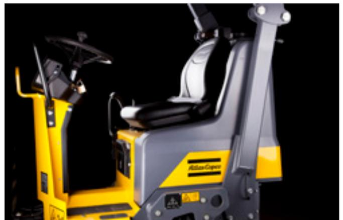
Una espaciosa plataforma de operador sin vibraciones y palancas de marcha delante /atrás para un confort total del operador.
