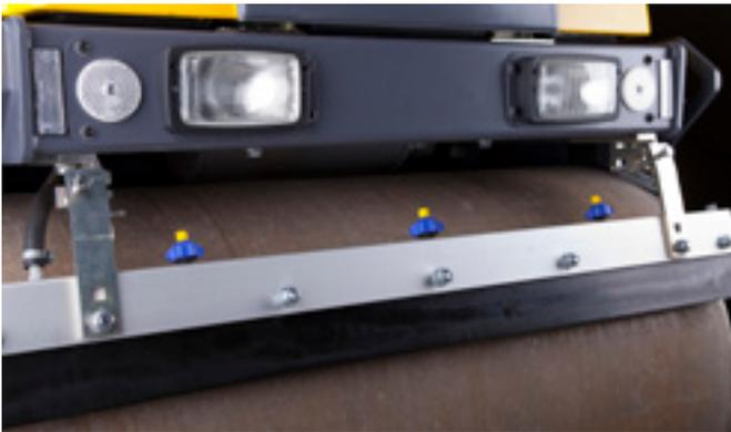
Tres boquillas en toda la gama CC1100-CC1300. Tres filtros en el sistema de riego aseguran la limpieza del agua. El temporizador de riego es estándar en el CC1300.
