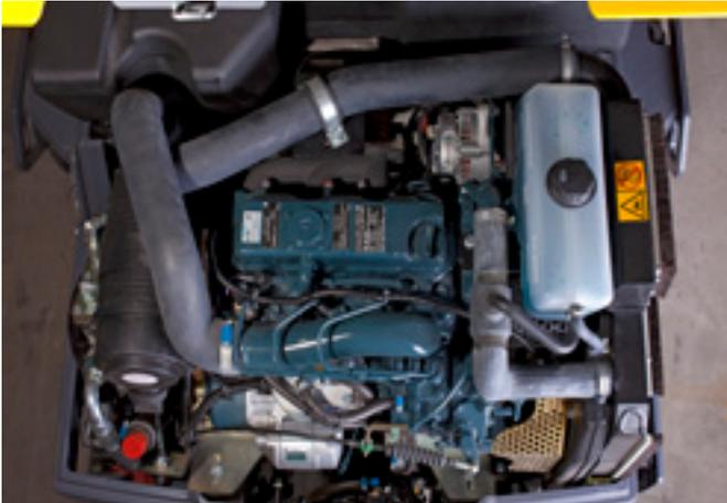
Motor Kubota refrigerado por agua muy silencioso. El capo robusto y de fácil apertura ofrece una gran accesibilidad.
