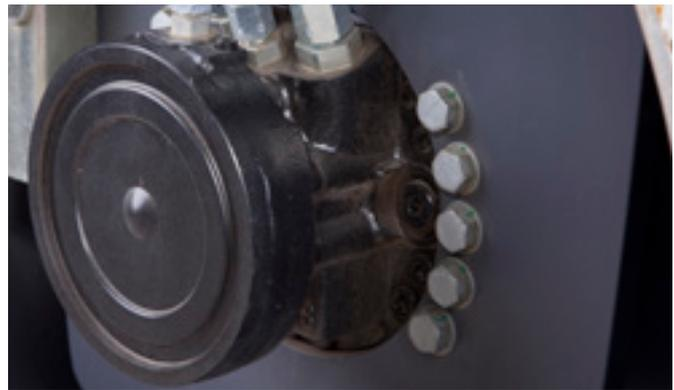
Ambos rodillos están equipados con frenos de seguridad (o sobre el rodillo + ruedas en versiones combi). Los frenos se bloquean automáticamente en caso de fallo del motor, del sistema hidráulico o del circuito eléctrico.
