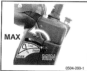
Con la palanca de ajuste puede regularse la velocidad del motor diésel entre marcha en vacío y régimen máximo de revoluciones. La palanca se fija en tres posiciones de enclavamiento. La palanca también puede colocarse entre las posiciones de enclavamiento.
