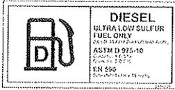
Para el motor diésel sólo debe utilizarse combustible diésel comercial con un contenido de azufre inferior al 15 mg/kg (15 ppm). Los intervalos de cambio de aceite de motor indicados sólo están concebidos para este combustible diésel.
